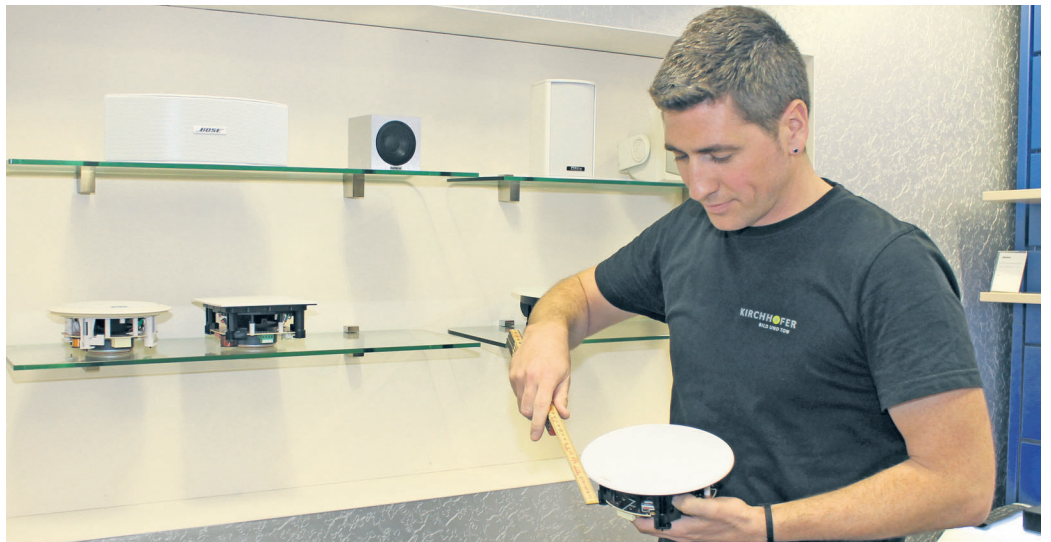
RTV-Elektroniker Urs Schneider mit einem Lautsprecher, der bei Neu- oder Umbauten direkt in die Wand eingelassen wird und dadurch fast unsichtbar ist.
